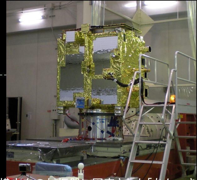
横方向の加振器に固定された「あかつき」
