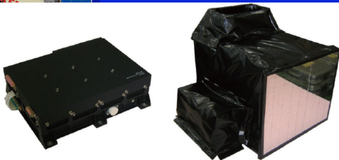
図1: LALT-E外観(左)と放熱板側から見たLALT-TR(右)
