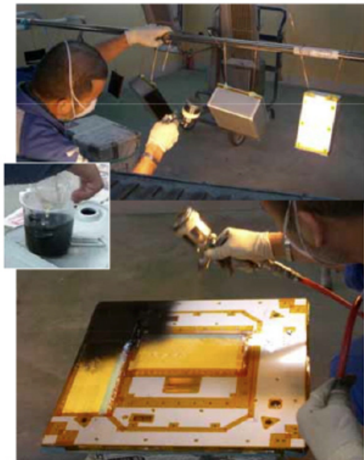
Fig11:塗布の様子（上下）、アストロブラック（中央左）
