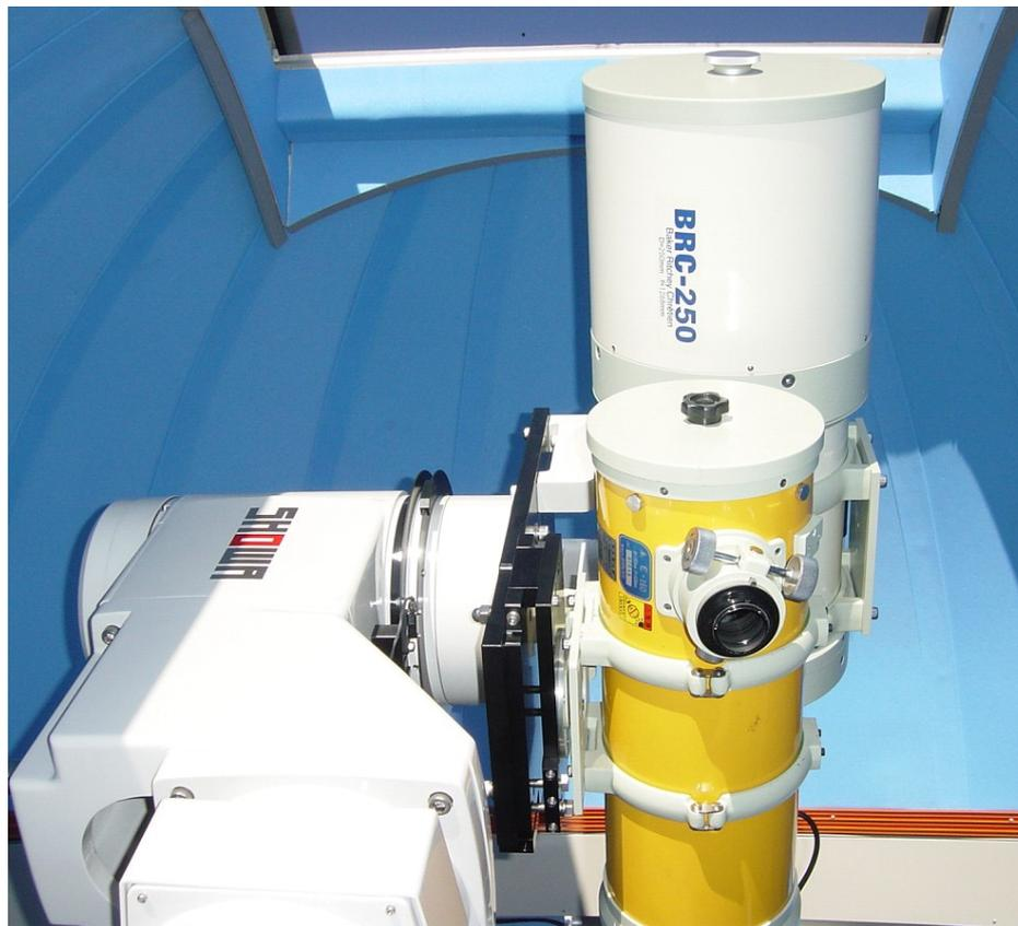
望遠鏡 BRC-250 (2台まで同架可能)
